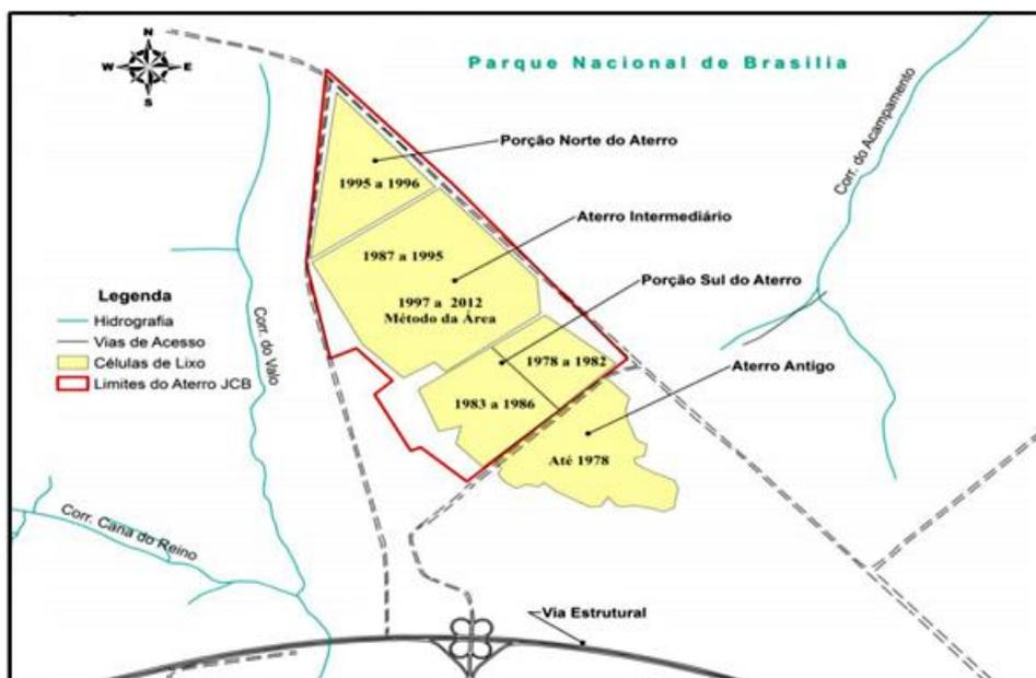
Figura 19 - Disposição das Células de RS no ACJ ao longo do tempo. (Fonte: Cavalcanti, 2013, adaptado de Santos, 1996).
