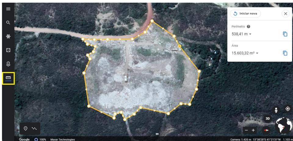
Figura 4.1: Medição de área de um lixão.
