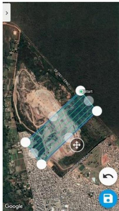
Figura 3-10 - Plano de voo 2 na interface do software Drone deploy
