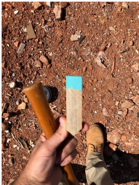
**Figura 3-7 - Piquete de madeira produzido para fixação dos alvos**
