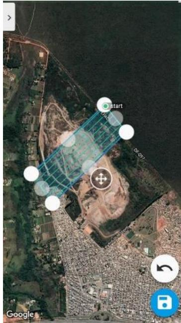
Figura 3-11 - Plano de voo 3 na interface do software Drone deploy
