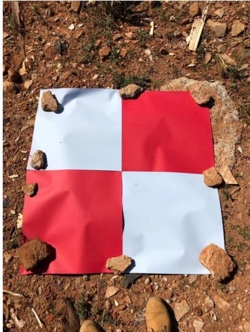
**Figura 3-17 - Segundo tipo de alvo confeccionado para servir de ponto de controle**
