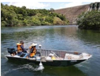
Figura 4.10: ADCP instalada na embarcação para realização de medições *in situ*.
