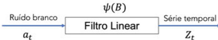
Figura 3.6: diagrama do teorema de decomposição de Wold com filtro linear para séries temporais.
