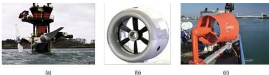
Figura 1.6: Turbinas hidrocinéticas carenadas: (a) Rotor livre, (b) Rotor carenado com gerador embutido *Straflow* e (c) Carcaça com difusor traseiro.
