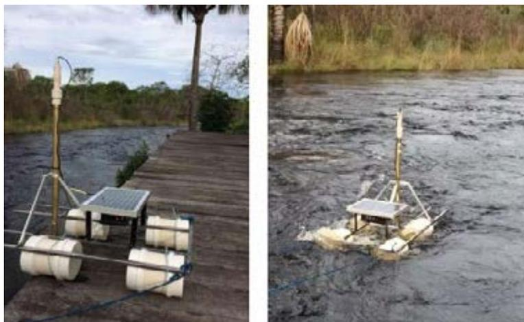
Figura 4.28: Conceito da boia de instrumentos em testes.
