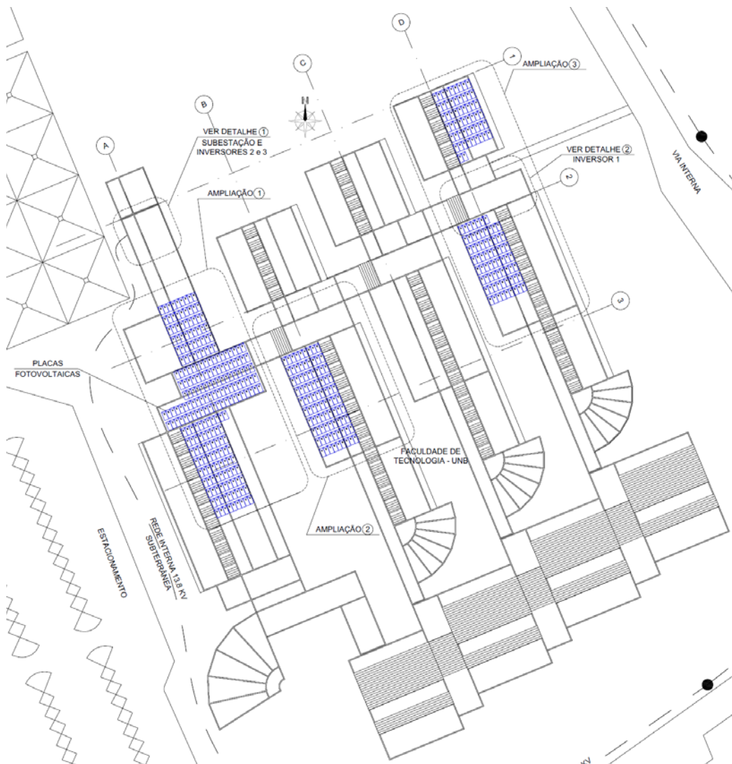
Figura 6. Alocação de módulos fotovoltaicos na Faculdade de Tecnologia
