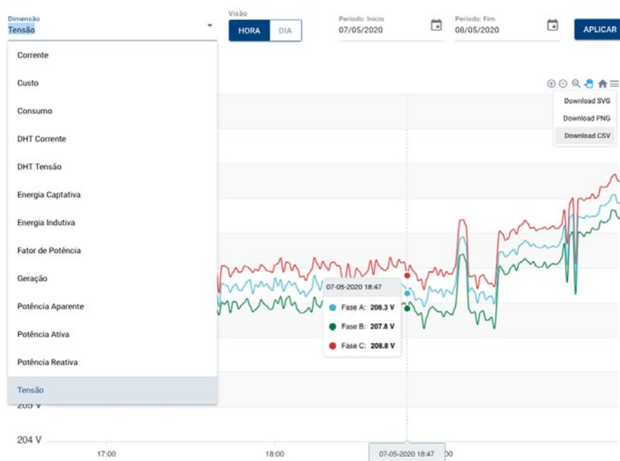
Figura 18. Gráfico de tensão mostrando o menu seletor das grandezas, os detalhes das grandezas com a posição do mouse e as opções de exportação de dados do gráfico
