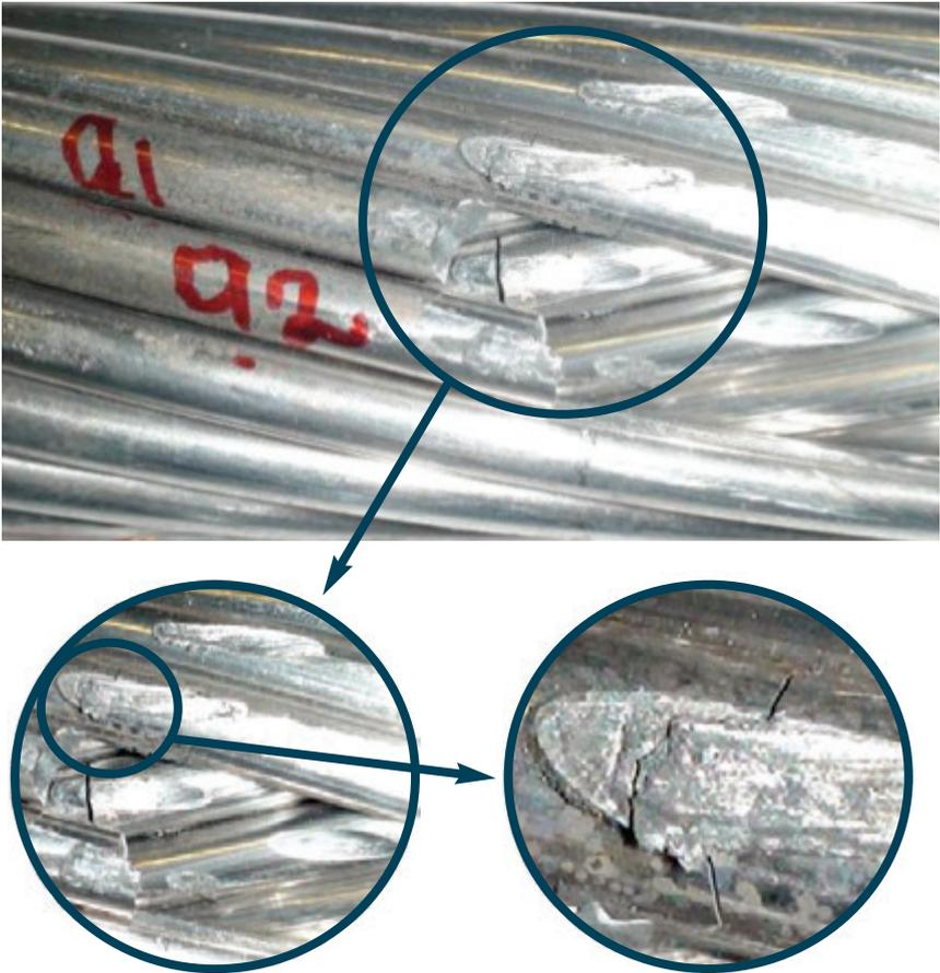
Montagem cabo/grampo de suspensão e vista ampliada mostrando a quebra dos fios de alumínio nas regiões danificadas por *fretting*. As quebras dos fios costumam ocorrer no interior do grampo, a uma distância DF (em torno de 27 mm) da sua boca.
